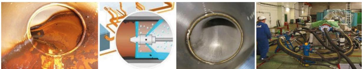
**Bild 1:** Demonstration der Technologie der hydrodynamischen Reinigung und der turbulenten Ölspülung des Schmiersystems einer rotierenden Maschine
