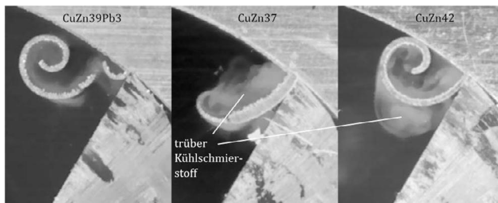
**Abb. 3:** Zerspannung der verschiedenen Messinglegierungen CuZn39Pb3 (links), CuZn39 (Mitte) und CuZn42 (rechts) mit einem Spanwinkel von  $10^\circ$  mit Synergy 735 auf Wasserbasis bei  $v_c = 80$  m/min und  $f_z = 0,05$  mm
