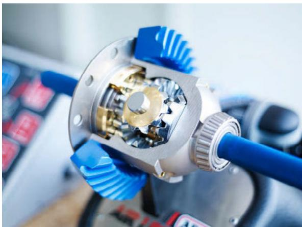
**Abb.:** Schnittmodell eines Achsantriebs mit Differenzial
