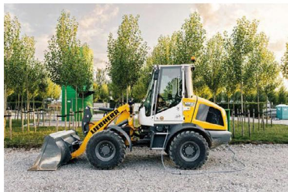
**Abb. 2:** Emissionsfrei unterwegs mit dem LIEBHERR-Radlader L 507 E (Bild: LIEBHERR)
