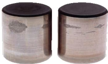
Durch falsche Schmierung können unterschiedliche Verschleißerscheinungen an Wälzkörpern und Lagerlaufbahnen auftreten.
