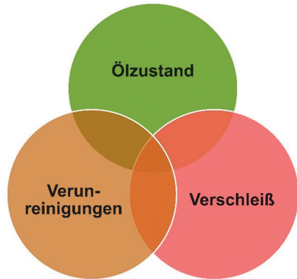
Abb. 6: Grundsätzliche Zielrichtung einer Routine-Ölüberwachung
