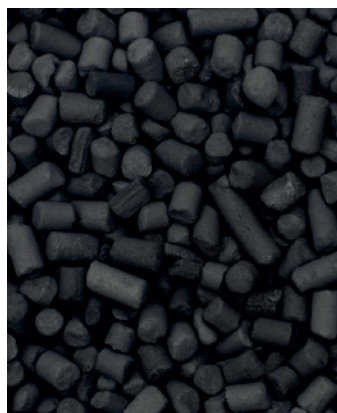
Abb. 3: Aktivkohle zur Biogasreinigung, Lieferung in Big Bag
