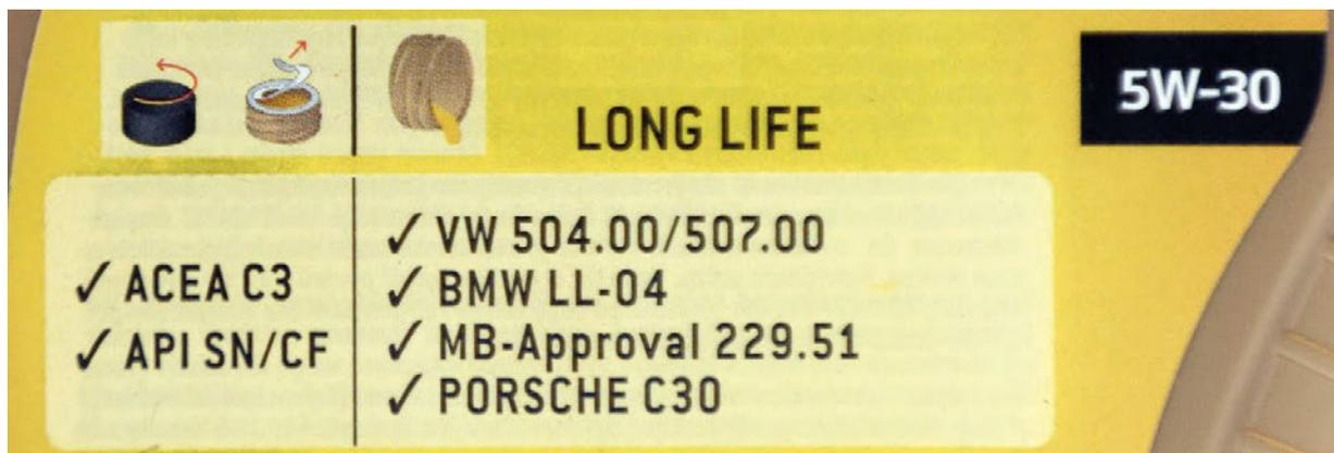
**Abb. 2:** Beispiel für die Angaben auf dem Etikett eines Motorenöl-Gebindes (OilDoc)
