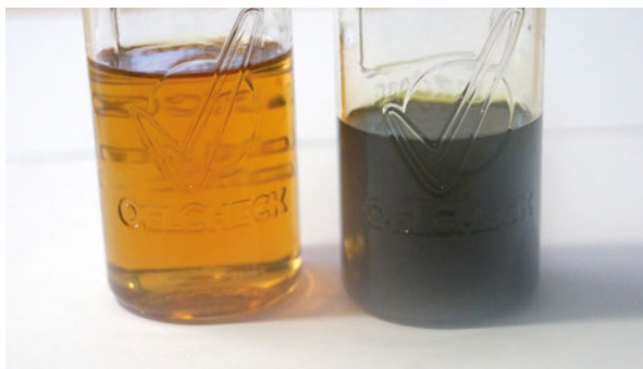
links: frisches Hydrauliköl, rechts: nach „Dieseleffekt“
