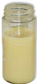
Hydrauliköl mit emulgiertem Wasser
