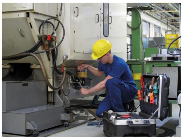
**Abb. 5:** Zur professionellen Schmierung von Wälzlagern in unterschiedlichsten Industrieanlagen bieten sich u. a. Zentralschmiersysteme an.
