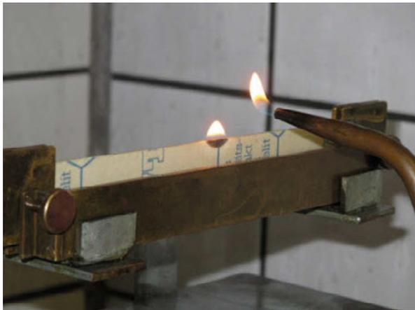
**Bild 6:** Prüfeinrichtung nach DIN EN ISO 14935 „Dochtprüfung“, DMT GmbH & Co. KG
