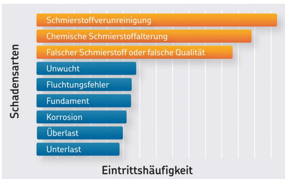
**Abb. 3:** Unterschiedliche Probleme mit dem Schmierstoff verursachen mit Abstand die häufigsten Störungen in Industriewerken.
